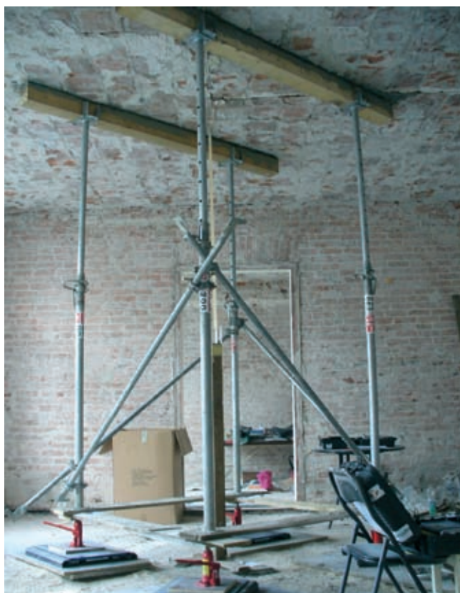
Rys. 3. Obciążenia z wykorzystaniem siłowników i elementów rusztowaniowych [4]
