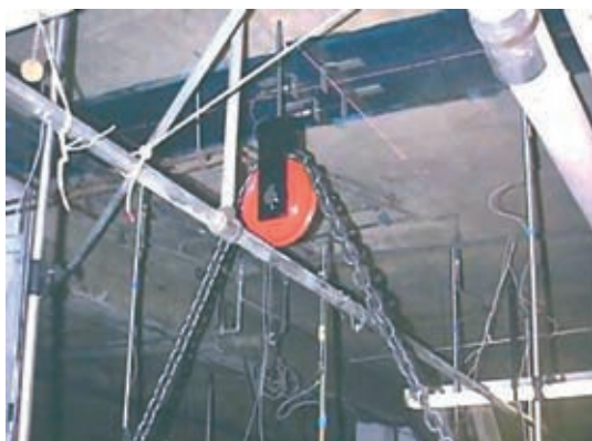
Rys. 4. Układ z ciągnami jako obciążenie próbne [2]
