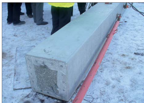
Fot. 1 | Słup zdemontowany dla pobrania próbek
