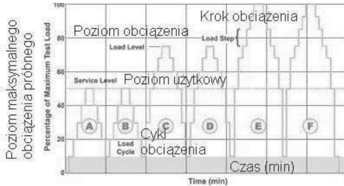
Rys. 4. Obciążenia zalecane w ramach technologii RapidLoad™ [13]
